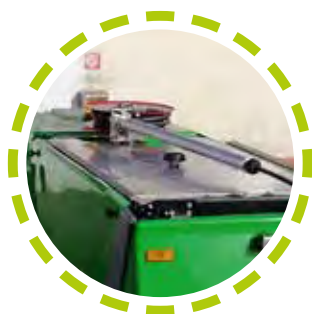
Braccio lavante rotante a 360° ad alta pressione con naspo e 10 metri di tubo 360° high pressure washing rotating arm with 10 metres hose
