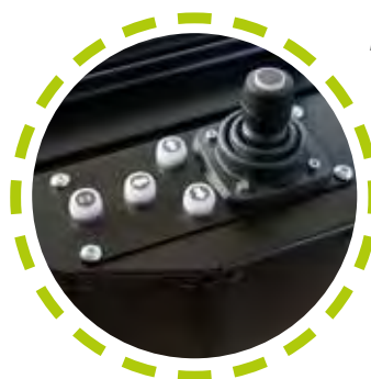
Joystick per il controllo manuale della barra di lavaggio Joystick for the manual control of the front washing bar
